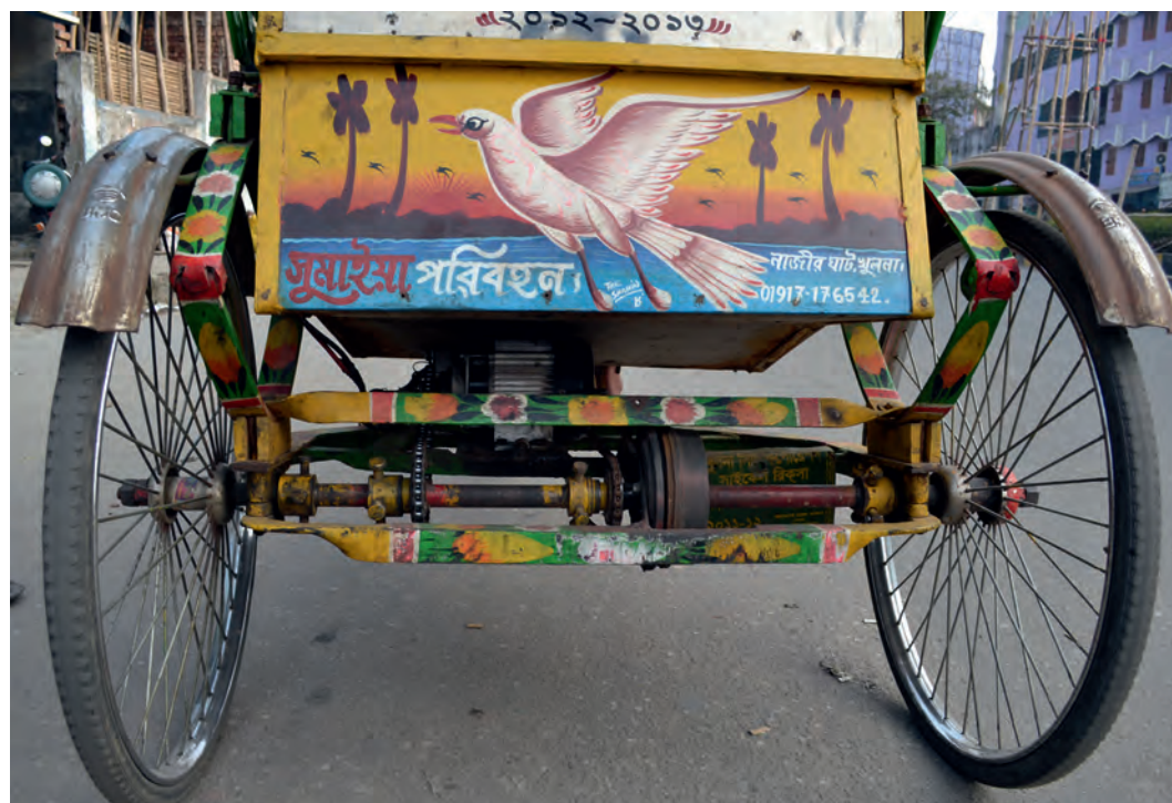
13. « E-rickshaw », depuis 2008, un petit moteur électrique alimenté par des batteries au plomb, équipe les rickshaw à vélo.
