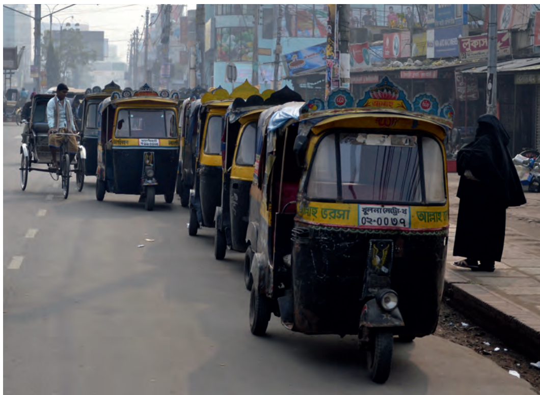
12. Khulna, où circulent les derniers « baby taxi » introduits au Bangladesh en 1980, des rickshaw à moteur à deux temps du constructeur indien Bajaj. Bangladesh, 2013
