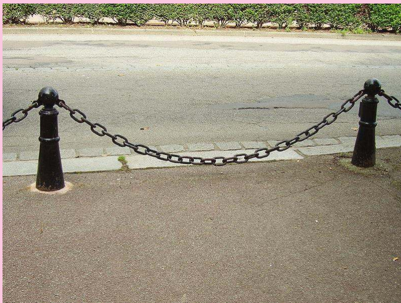
Figure 3 : La courbe de la chaînette, qui peut être déduite du principe de moindre action (Image WikiCommons Kamel15)
