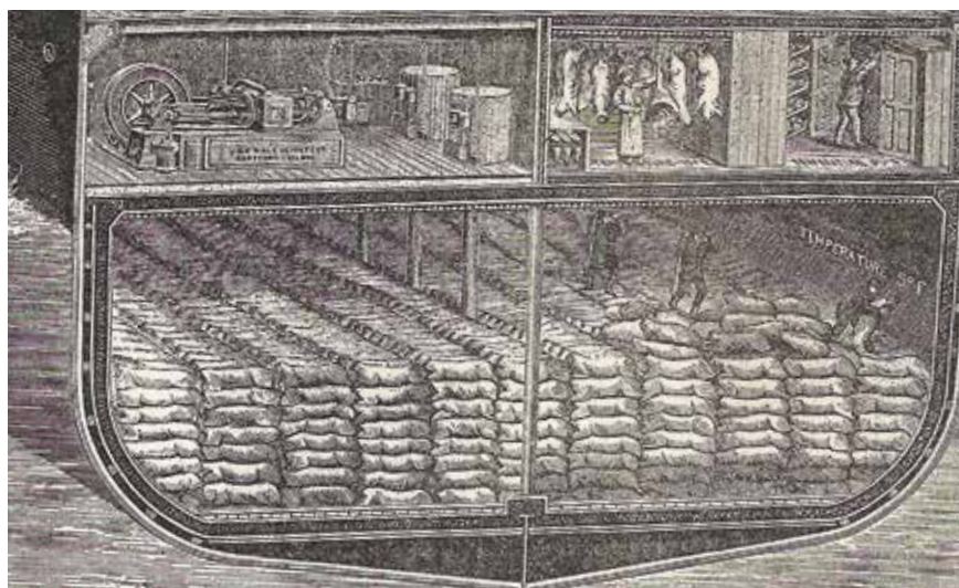
3. Dessin en coupe d'un navire frigorifique en 1913. Le frigo est certainement l'objet le plus évident pour évoquer la conservation dans une perspective moderne et occidentale. Il constitue la part visible de transports d'aliments, liant mangeurs, producteurs et transformateurs via des chaînes techniques parfois transcontinentales.
