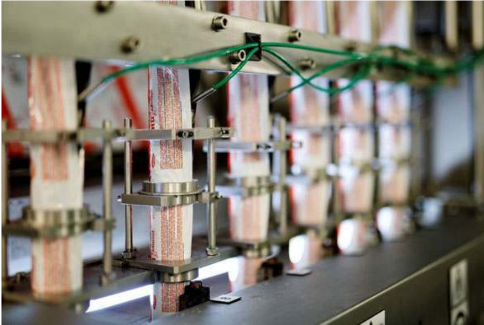
Ensacheuse six pistes formant et remplissant les sachets.
