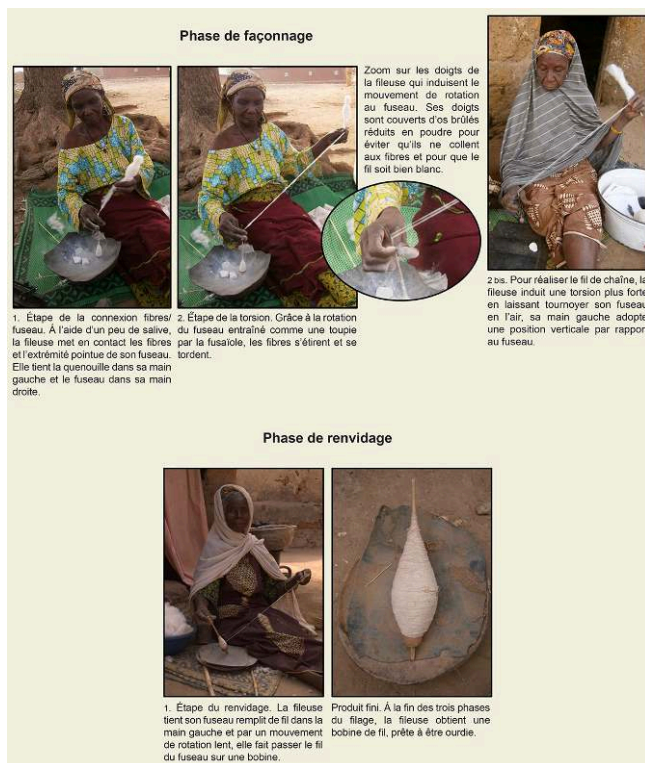
Figure 4 : Phase de façonnage : étape de la connexion fibres/fuseau, étape de la torsion, étape alternative du façonnage de fil de chaîne. Phase de renvidage : étape du renvidage
