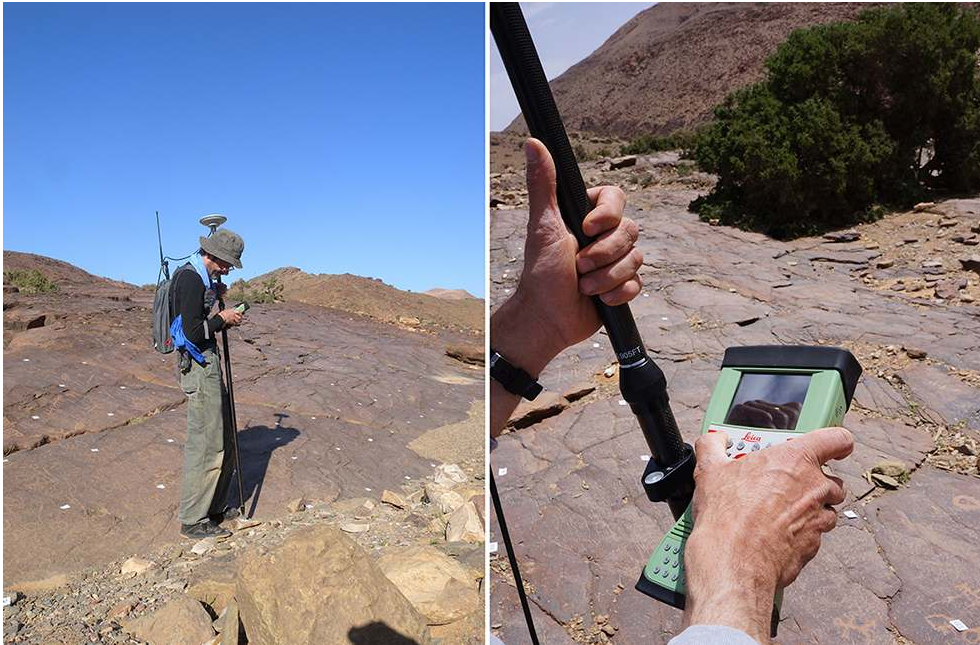
Le relevé topographique de la dalle, avec un GPS différentiel. Phot. Mission Paysages Gravés. © Mission Paysages Gravés.
