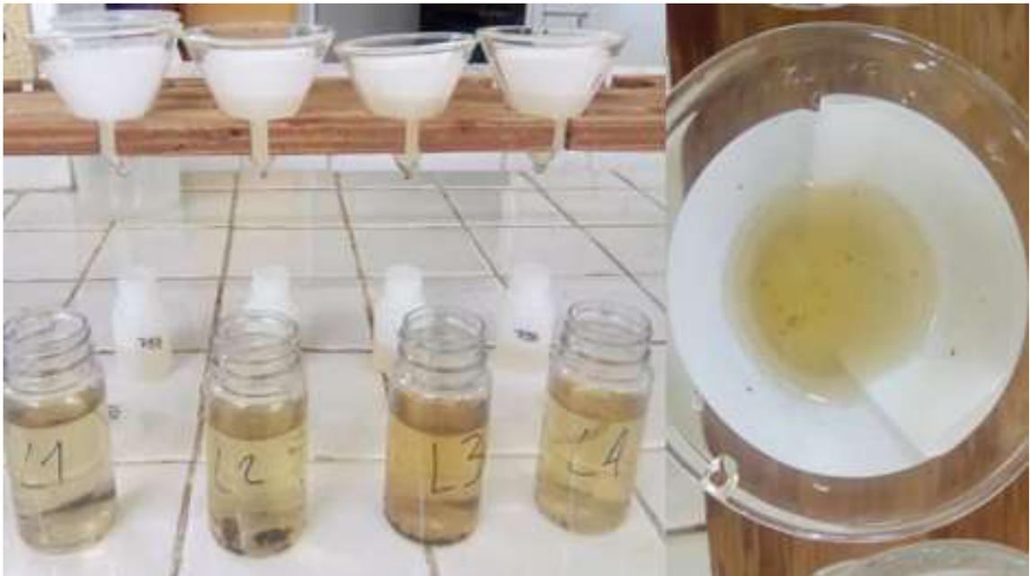
Figura 6. Filtrado de muestras, para eliminación de impurezas después de la colecta.
