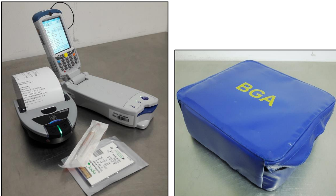
Abb. 5: Alere epoc®: epoc-Host-Bedienteil, epoc-Reader-Messeinheit, epoc-Drucker, epoc-Messkarte und Sarstedt-BGA-Monovette® sowie Transporttasche des RDMH
