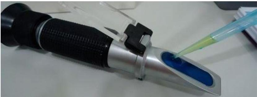
**Figura 12: Avaliação das proteínas totais com refratômetro clínico (Fonte: [www.milkpoint.com.br](http://www.milkpoint.com.br)).**
