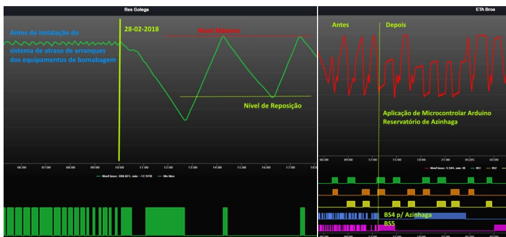
Figura 1-2: Diferenças de funcionamento, antes e depois de introdução dos Arduinos
