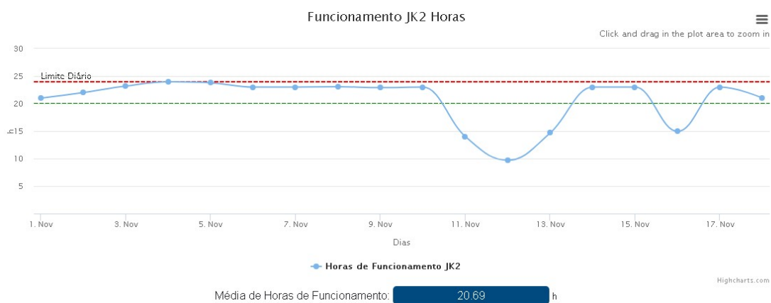
Figura 5-23: Estatísticas de horas de funcionamento da bomba do furo JK2 ao longo do mês
