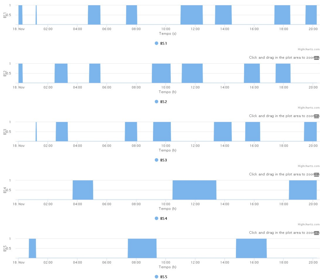
Figura 5-19: Funcionamento das bombas hidropressoras durante o dia.
