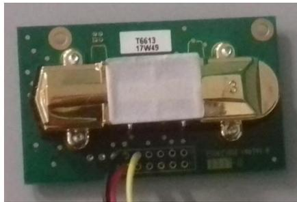
Figura 11 – Sensor de Dióxido de carbono
