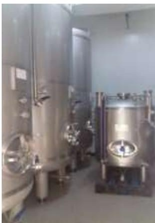
Figura 23 - Tanques de maturação (Santos, C.(2017))
