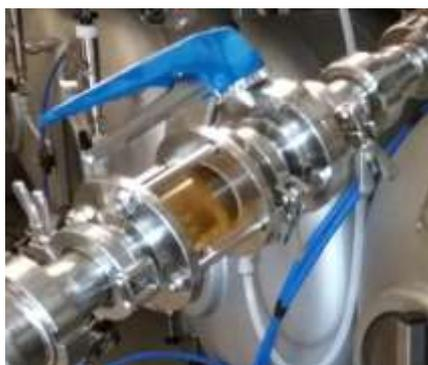
Figura 22 - Visor utilizado numa trasfega (Santos, C.(2017))
