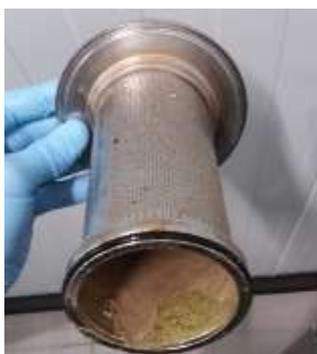
Figura 18 - Final da filtração filtro com bastante lúpulo e outras partículas
