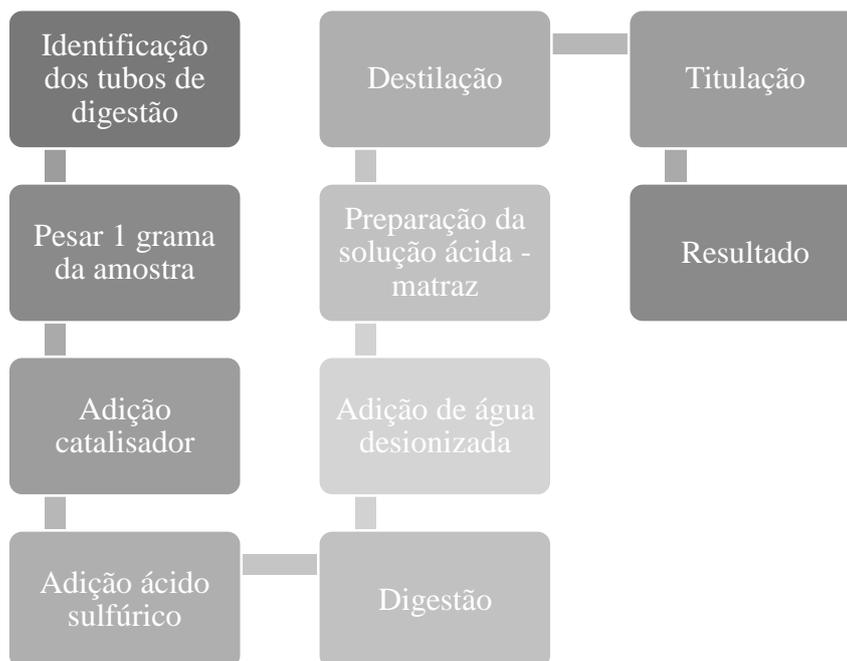
Figura 5: Fluxograma método de Kjeldahl
