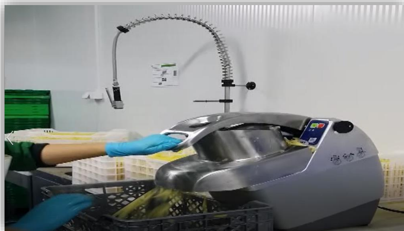
Figura 11: Corte da batata descascada na cortadora TRS.
