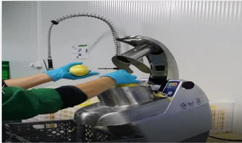
Figura 10: Colocação da batata descascada na cortadora TRS.
