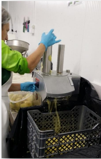
Figura 12: Corte da batata aos palitos 8/8 na cortadora CA-601 da Sammic.
