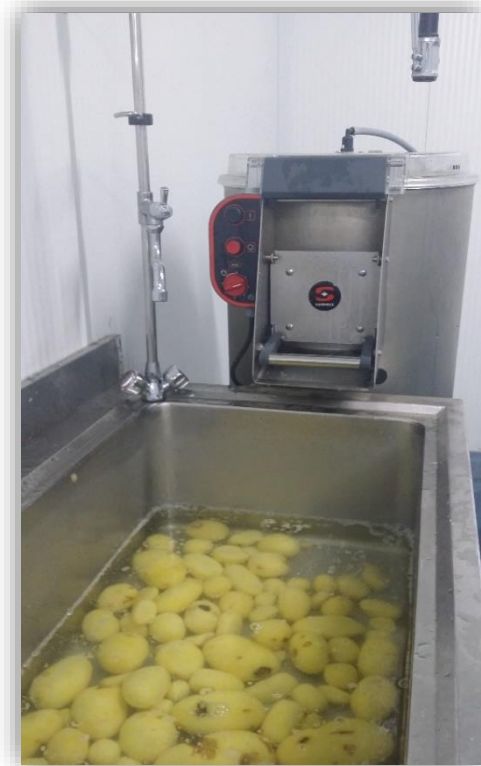
Figura 9: Tanque com água para onde são lançadas as batatas descascadas.
