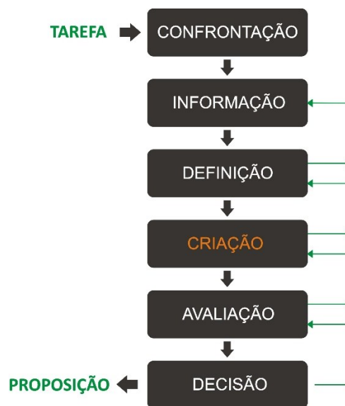
Fig. 41 - Processo de resolução dos problemas de Pahl et al. (2007). Fonte: adaptado pelo autor.
