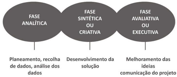
Fig. 4 - Processo projetual de Jones (1963) e Archer (1965). Processo linear ligado ao problem solving, visto como uma seqüência de fases ordenadas unidireccionalmente. Fonte: o autor.
