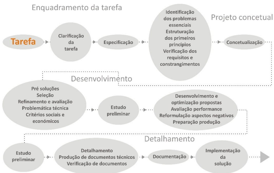
FIG. 23 - PROCESSO METODOLÓGICO DE DESIGN DE PAHL E BEITZ (1984). FONTE: ADAPTADO DE ALMENDRA (2010).
