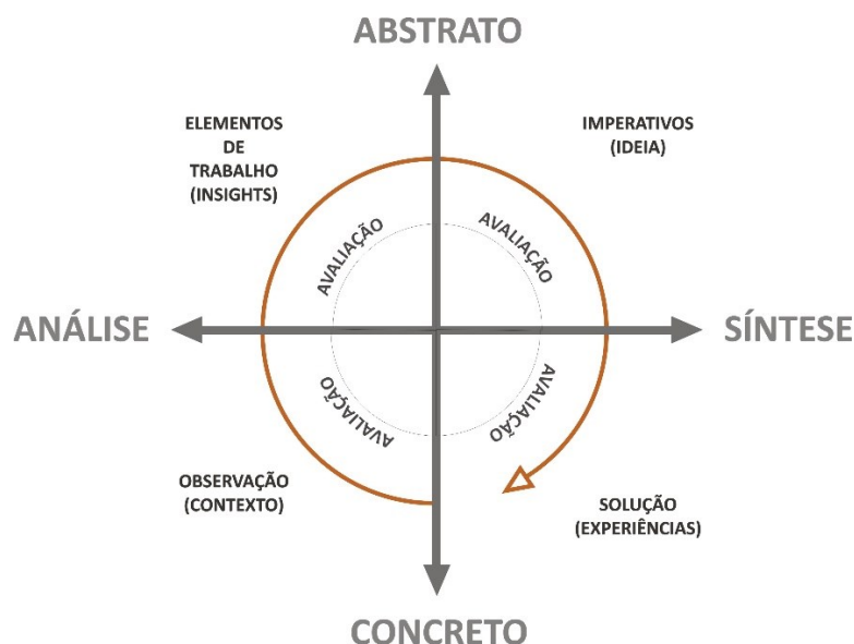
FIG. 54 - MODELO DO CICLO DE PENSAMENTO EM DESIGN. FONTE: ADAPTADO DE BECKMAN E BARRY (2009, p.153).
