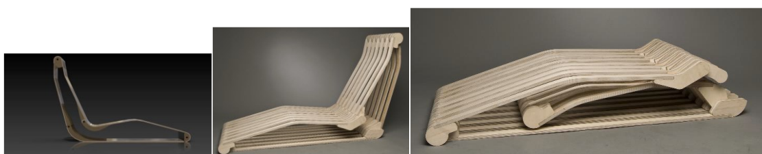
Fig. 70 - Modelos digitais e protótipo final da Chaise Box realizado com a tecnologia digital CNC Tupia no 3D LAB – IADE Creative University.
