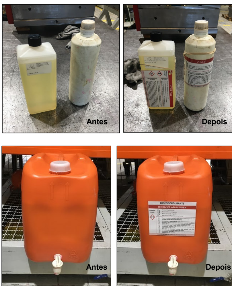
Figura 17 – Exemplos da colocação de etiquetas de identificação de produtos químicos.
