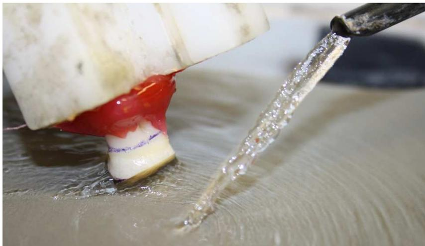
Figura 11 - Simulação do *smear layer* na máquina polidora (LaboPol-4, Struers, A/S, Ballerup, Denmark)
