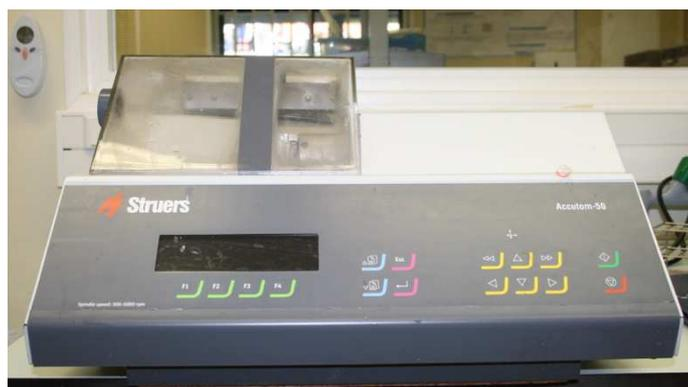
Figura 9 – Micrótopo de tecidos duros (Accutom-50, Struers A/S, Ballerup, Dinamarca)
