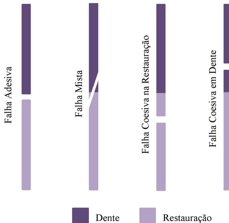
Figura 20 - Esquema ilustrativo do tipo de falhas
