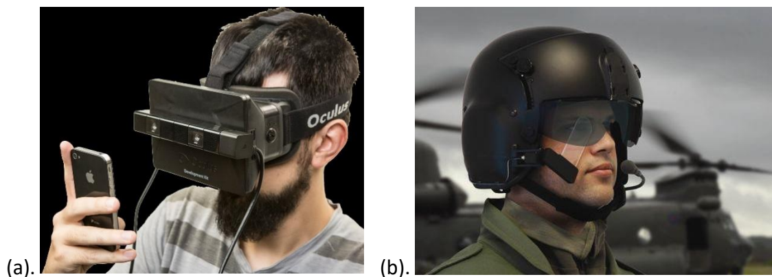
(a). Figura 18. (a) visor frontal de observação por vídeo [Fonte: adaptado de (D`Angelo, 2016)]. (b) Visor frontal de observação ótica [Fonte: adaptado de (Systems, 2012)]
