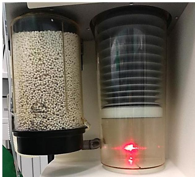
*Figura 78 - Sensor ótico (foto do Autor)*
