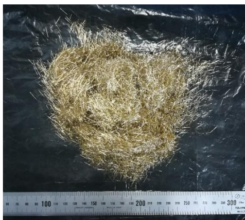
Figura 3.12 – Aspeto macroscópico das fibras utilizadas
