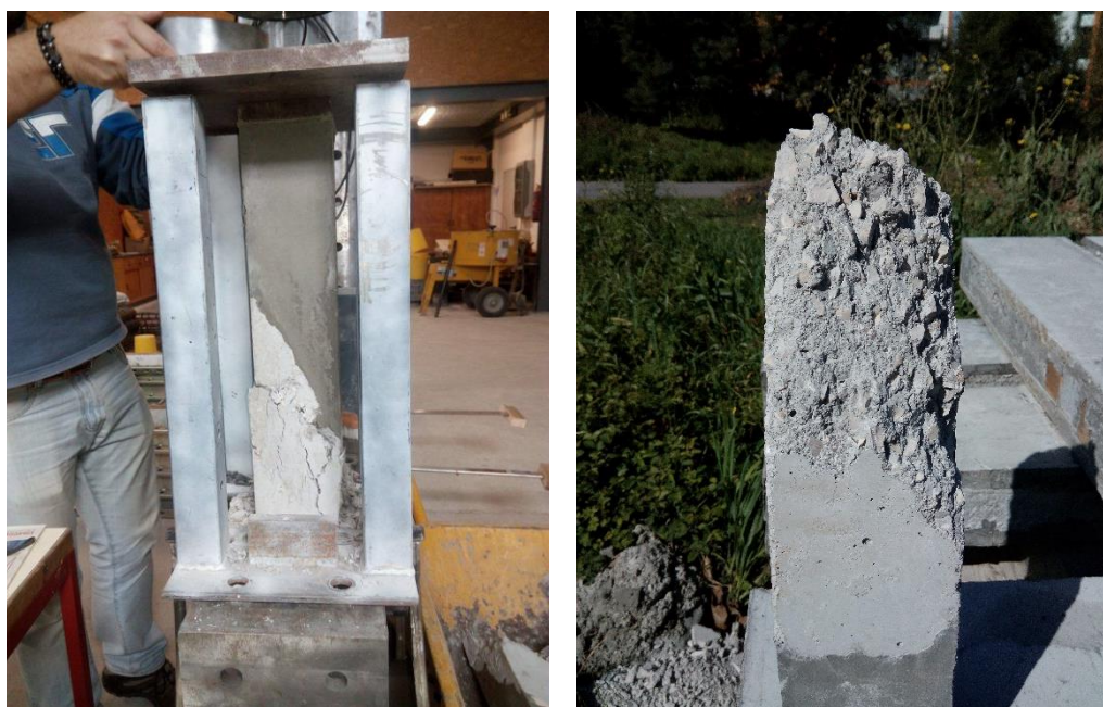
(a) rotura coesiva
