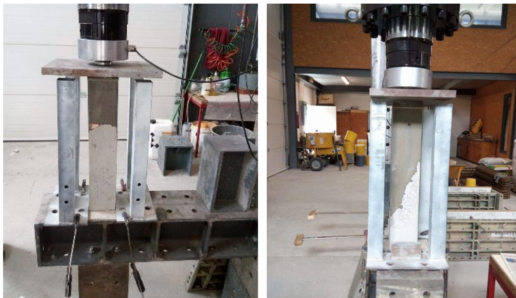
Figura 3.5 – Ensaio de provete de corte inclinado
