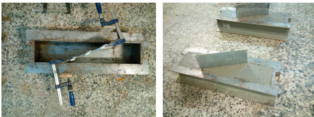
a) colocação de chapa nos moldes.
