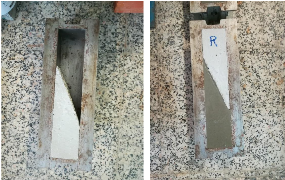
Figura 3.1 – Produção das metades de substrato dos provetes de corte inclinado (a, b1, b2 e b3)
