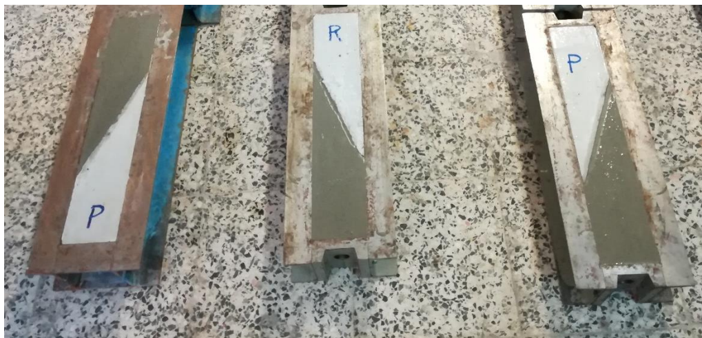
Figura 3.2 – Preparação e betonagem final dos provetes de corte inclinado
