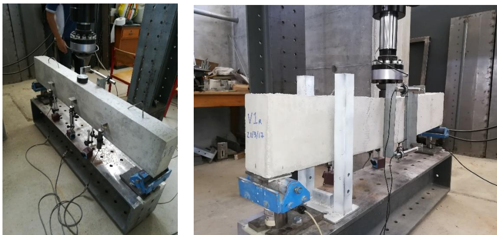
Figura 3.27 – Viga preparadas para ensaio e durante o ensaio
