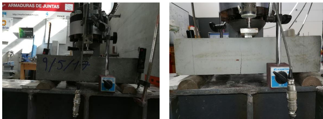
Figura 3.13 – Ensaio de tração por flexão
