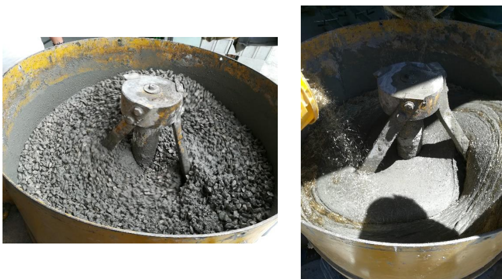
Figura 3.22 – Execução de amassaduras
