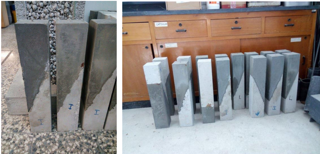
Figura 3.3 – Provetes do ensaio de corte inclinado
