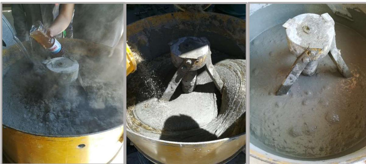
Figura 3.33: Execução das amassaduras de UHDC
