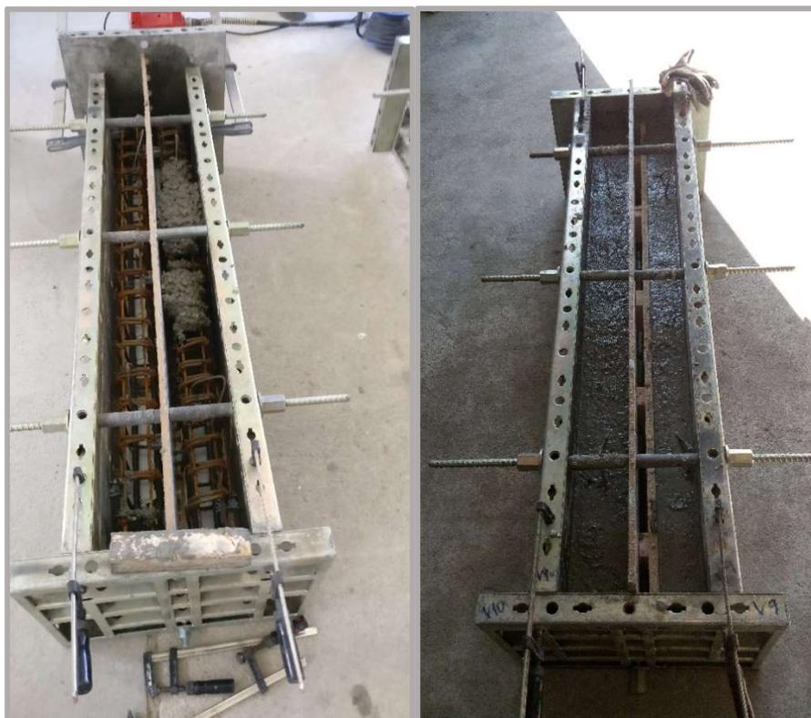
Figura 3.30: Betonagem, com vibração, e cura das vigas
