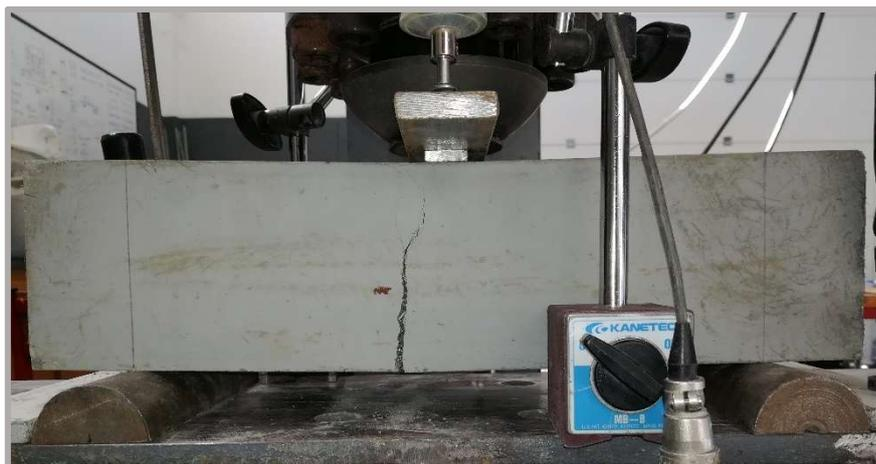
Figura 3.9: Ensaio de tração por flexão
