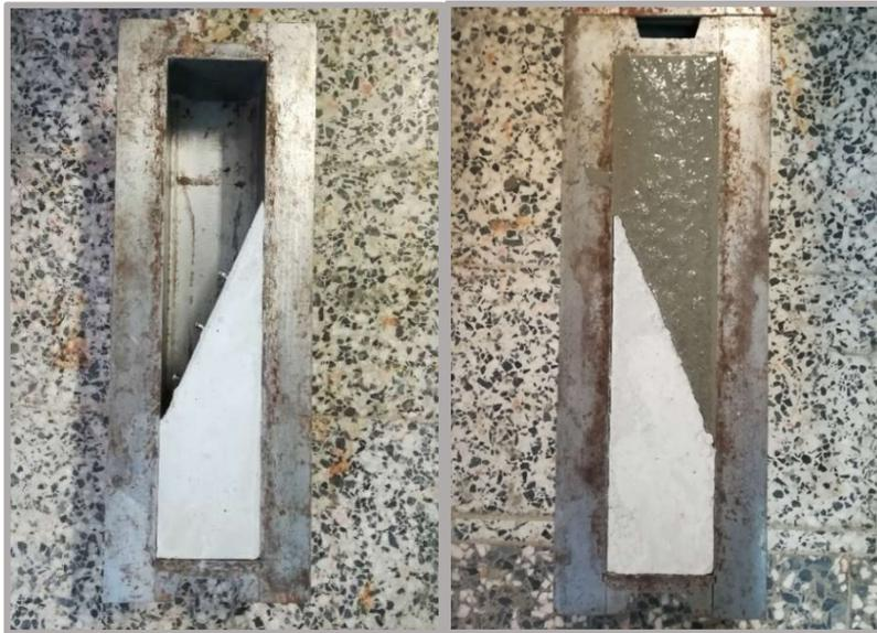
Figura 3.15: Preparação e betonagem final dos provetes de corte inclinado
