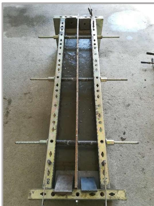
Figura 3.34: Betonagem e cura da *superskin*
