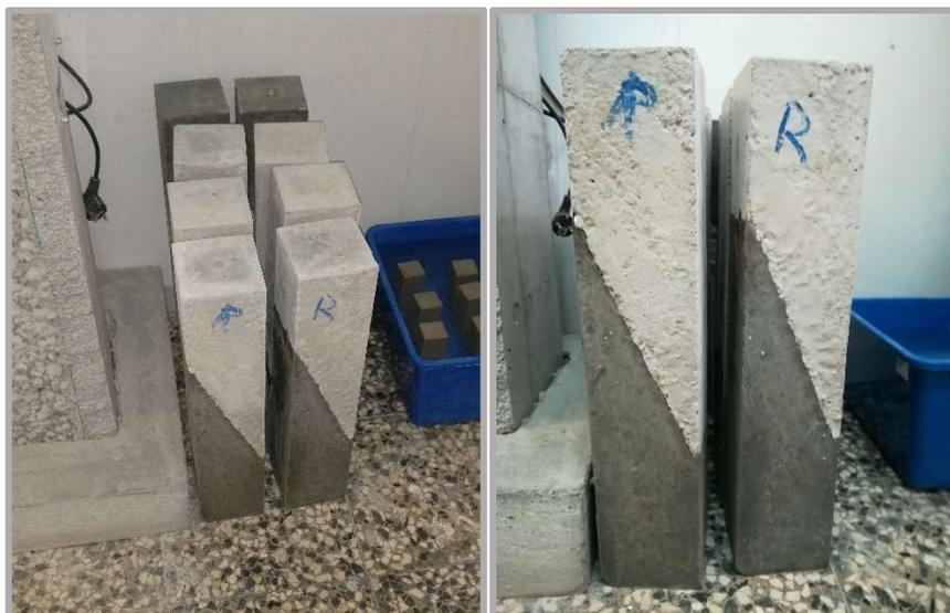
Figura 3.17: Provetes do ensaio do corte inclinado
