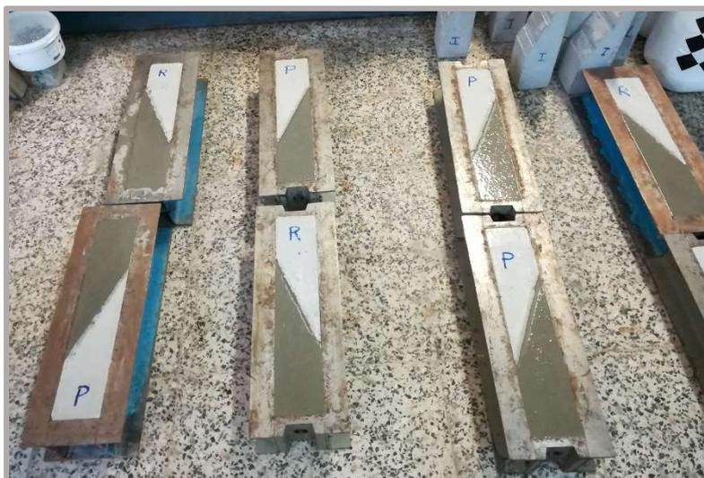
Figura 3.16: Moldes betonados com as duas partes do provete
