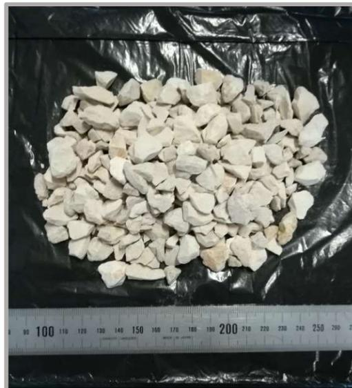
Figura 3.3: Aspeto macroscópico do agregado grosso (Brita 6/14 mm)
