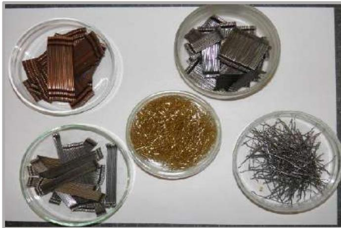
Figura 2.5: Exemplos de fibras metálicas (Sousa, 2014)
