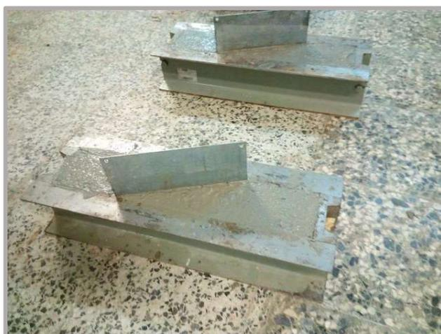
Figura 3.13: Moldagem da metade de LBC dos provetes – Interface lisa (sem tratamento) e rugosa
