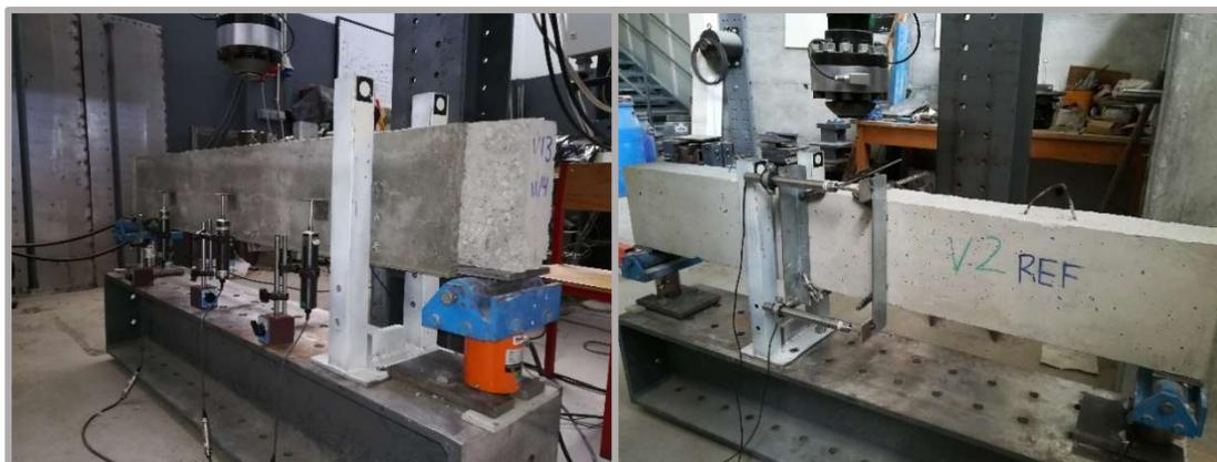
Figura 3.37: Viga preparada para ensaio à flexão
