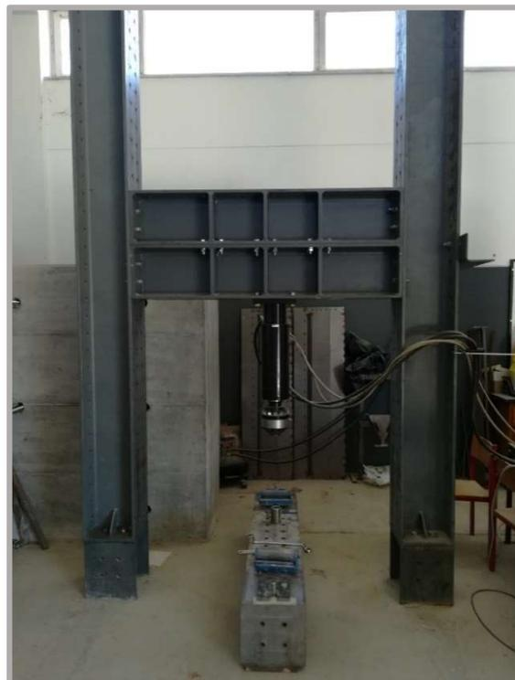
Figura 3.36: Pórtico de Ensaio
