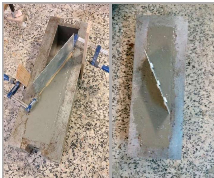
a) Interface com conetores    b) Interface indentada
