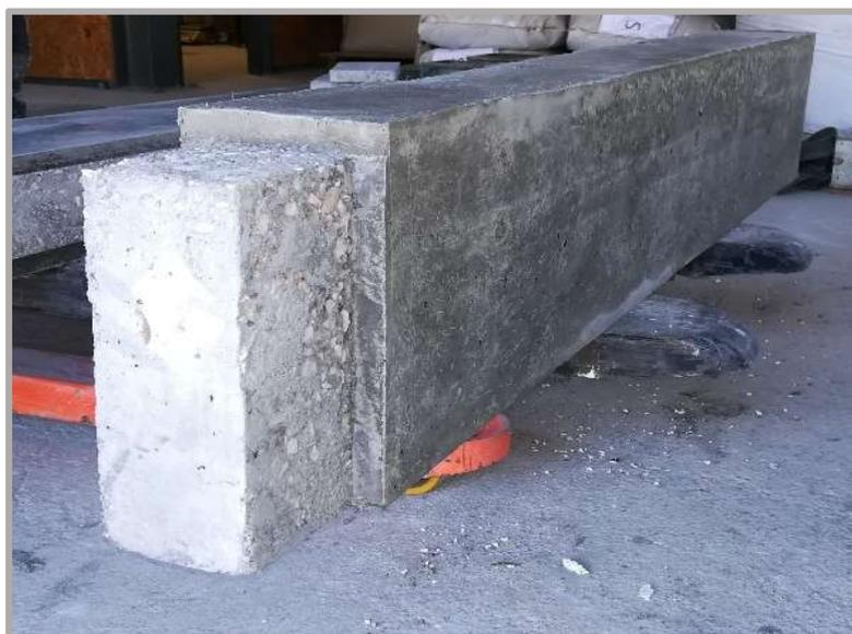
Figura 2.9: Elemento com interface rugosa entre LBC e UHDC
