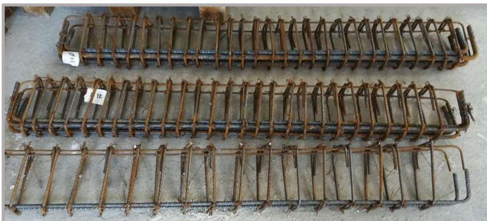
Figura 3.6: Aspeto das armaduras utilizadas nas vigas
