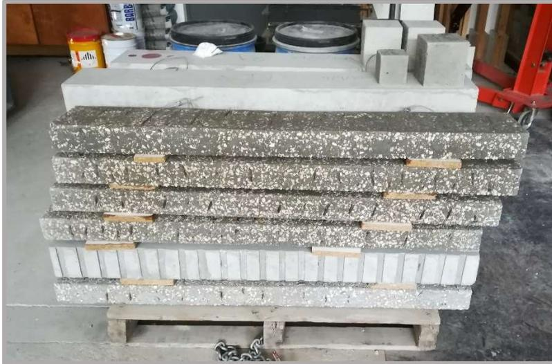
Figura 3.31: Vigas com betão de baixa dosagem de cimento, LBC – vigas de referência e núcleos
