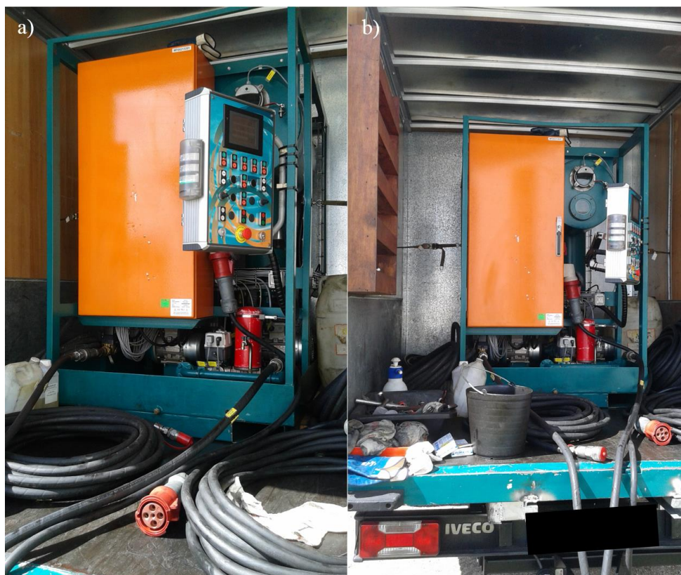
Figura 6.5 – a) Máquina purificadora do óleo, b) inserção da máquina purificadora no seu veículo de transporte.
