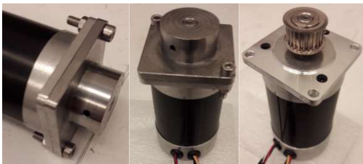
Figura 5.48 - Montagem do novo molde de furação no motor
