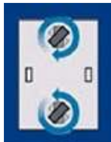
Figura 3.14 - Exemplo de combinação de diferencial e direcionável
