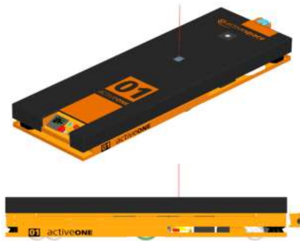
Figura 4.16 - Ilustração do detector de presença de carga
