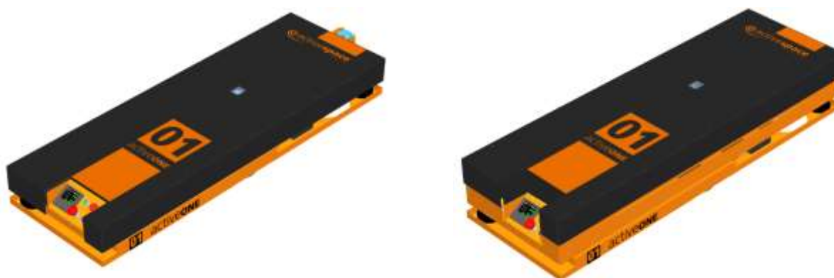
Figura 4.4 - Active ONE Elevador - plataforma baixa à esquerda e elevada á direita
