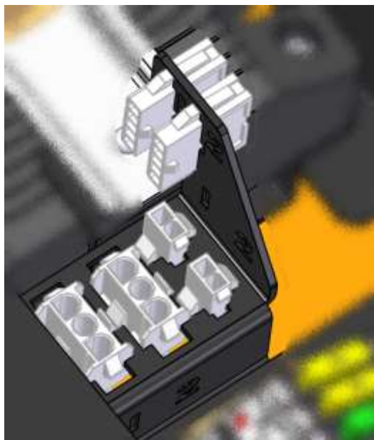
Figura 5.35 - Fichas de painel e a sua identificação no Suporte do controlador dos motores
