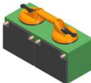
Figure 4.5: Aplicação da ventosa nas baterias
