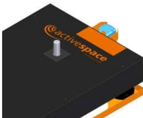
Figura 4.13 - Vista do pino de reboque
