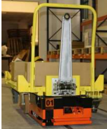
Figura 4.5 - Active ONE de Elevação carregando um Chariot de mercadoria
