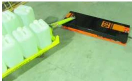
Figura 4.6 - Active ONE de reboque transportando um carrinho de mercadoria
