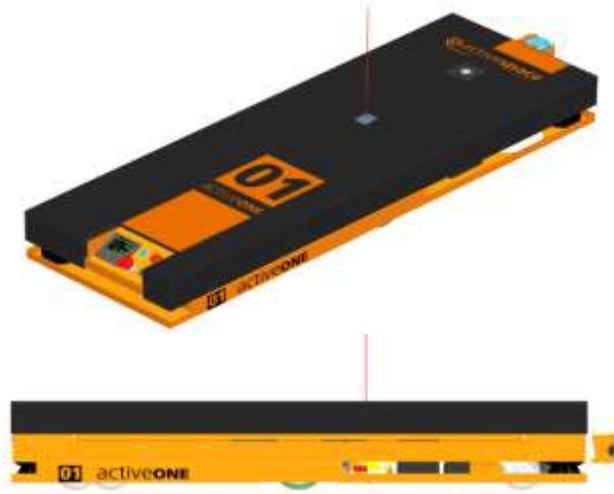
Figura 5.23 - Ilustração do feixe da fotocélula exterior ao Active ONE
