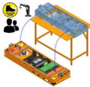
Figure 4.14: Remoção do ActiveONE da bancada de manutenção
