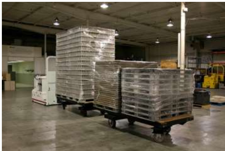
Figura 3.5 - AGV transportando vários atrelados num ambiente de fabril
