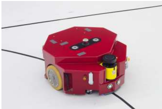
Figura 3.9 - Navegação por cabo enterrado
