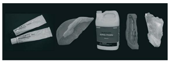
FIG. 5.1.3.2-1 – Técnica de fabrico de réplicas em resina de poliéster com Coltene Light President e resina Epoxy.
