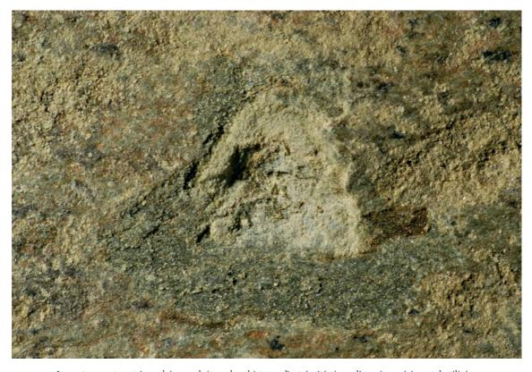
$_{\text{FIG.}7,2.2-11}$  – Impact au contour triangulaire produit sur le schiste par l'extrémité aigue d'un pic expérimental utilisé en percussion lancée.
