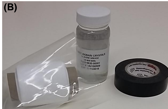
Figura 5.1: Materiais usados para a montagem do detetor de cintilação. (A) Cristal cintilador e fotodíodo. (B) Fita branca de teflon, silicone para acoplamento óptico e fita isoladora preta.
