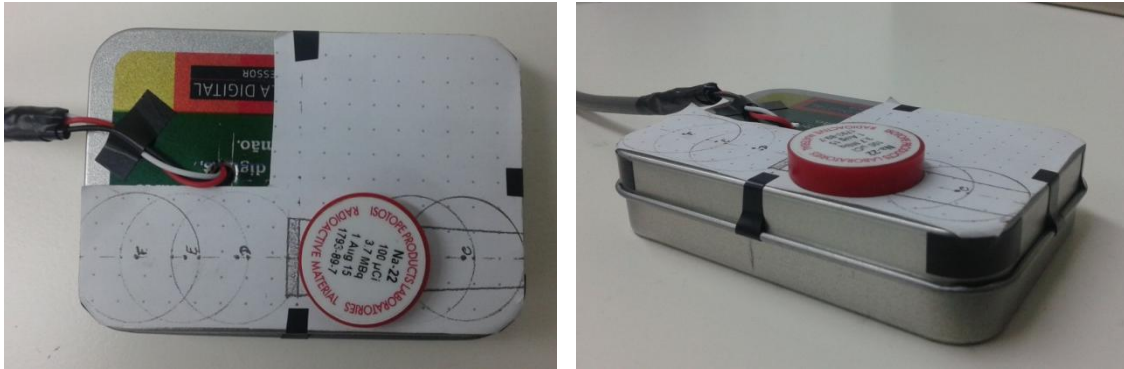
Figura 6.3: Fonte radioativa de ^{22}\text{Na} localizada sobre o cristal cintilador e a 1 cm do fotodíodo.
