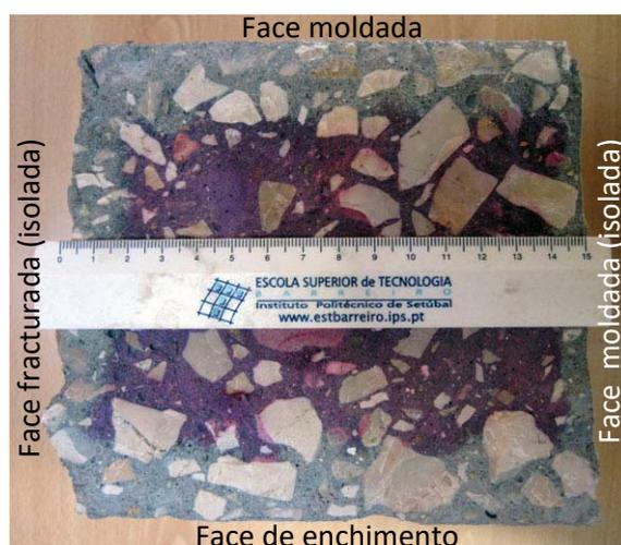
Figura 4. Medição da profundidade de carbonatação.
