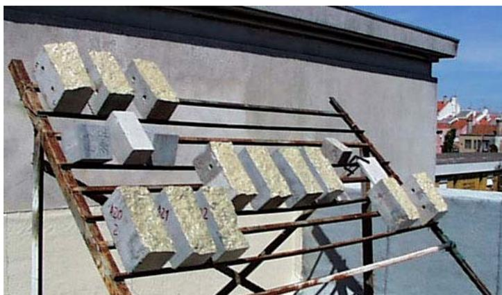
Figura 3. Provetes em exposição no terraço do LNEC.
