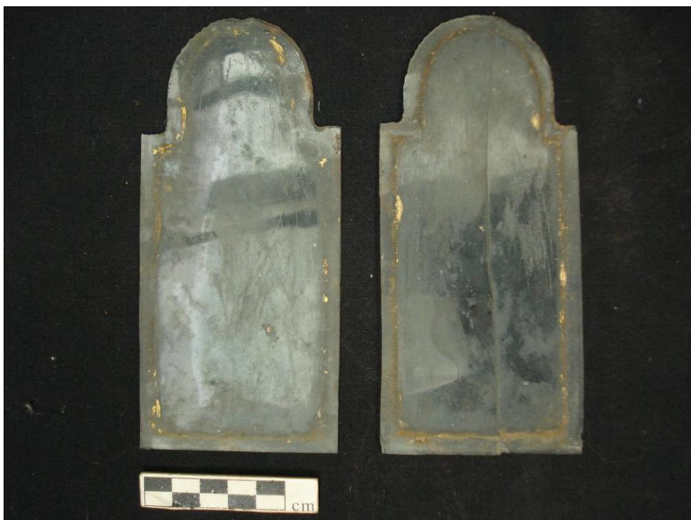
Figura 10. Vidro das portas das ilhargas do corpo superior. Observam-se as marcas contínuas a dourado que indicam que as portas receberam tinta após ter sido colocado o vidro<sup>77</sup>.
