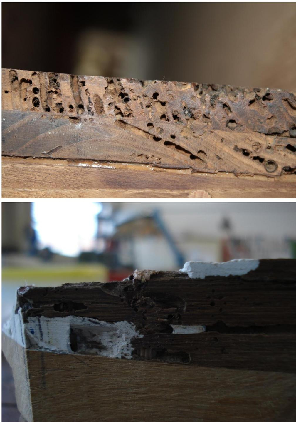
Figura 17. Estado de conservação do suporte, caixa do corpo inferior e frisos da base. Pode-se observar os orifícios e galerias formados pelo ataque e deposição de insectos xilófagos, que deram origem à perda generalizada de matéria<sup>89</sup>.
