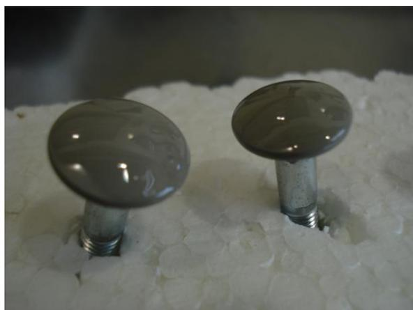
Figura 38. Fase de secagem, após aplicação de uma camada de preparação com um primário de cor cinzenta nos elementos metálicos novos dos apêndices<sup>143</sup>.
