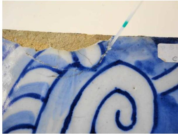
Fig. 67 – Fixação pontual de vidro
