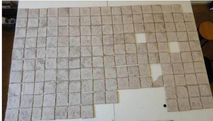
Fig. 42 – Apainelamento com o tardo voltado para cima para facilitar o levantamento das marcas existentes.
