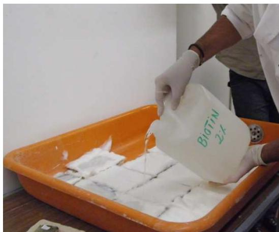
Fig. 64 – Aplicação do biocida
