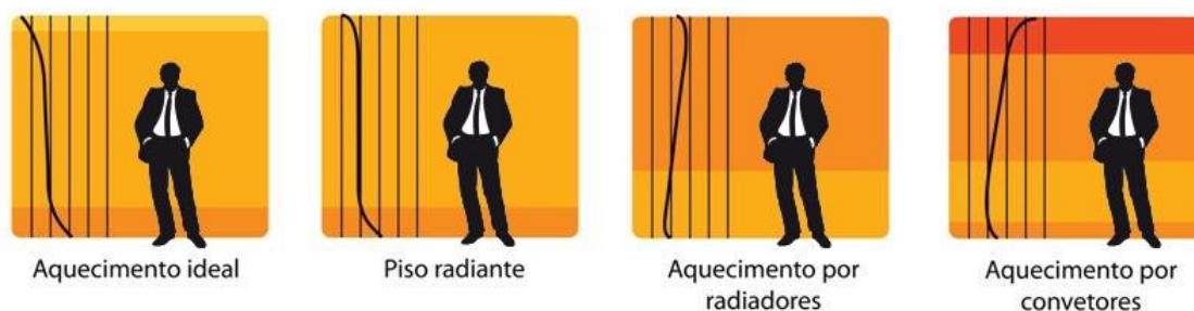
Figura 2. 13 Gráficos de distribuição da temperatura para diferentes sistemas de aquecimento (Macolis FR, 2016)
