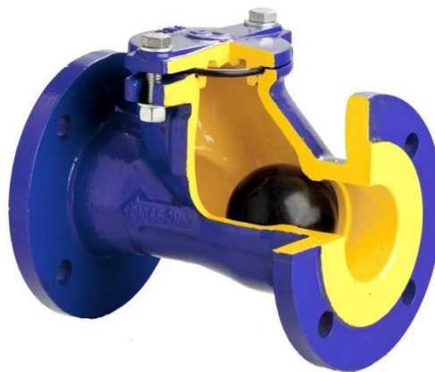
Figura 2. 17 Imagem Ilustrativa de uma válvula de retenção de esfera (Zetkama, 2016)
