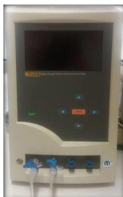
Figura 18 - Equipamento teste de fluxos e oclusões.
