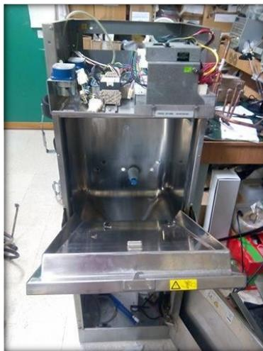
Figura 41 - Máquina termo desinfeção em reparação.
