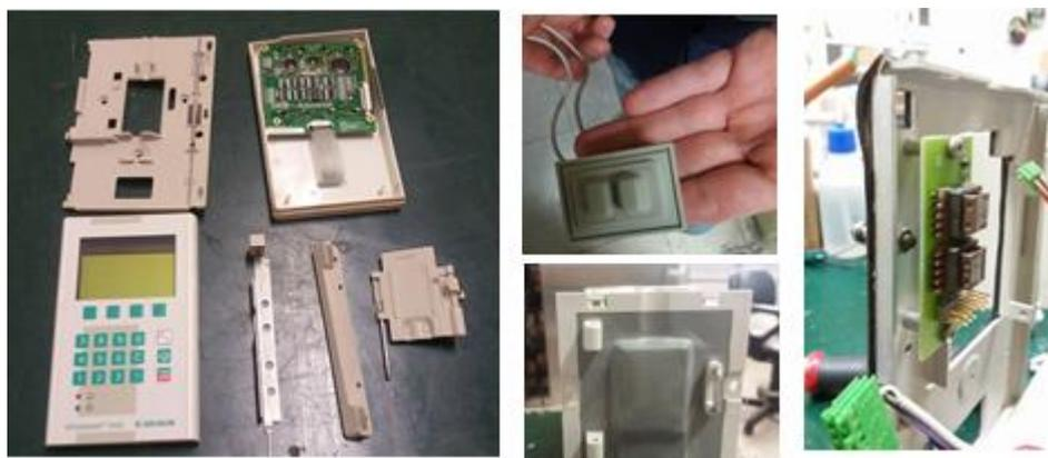
Figura 56 - Exemplos de peças substituídas.
