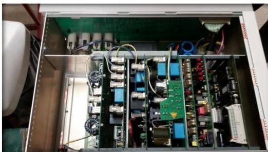
Figura 64 - Placas interiores do eletrobisturí.
