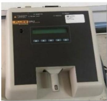
Figura 17 - Equipamento de teste de  $SpO_2$ .
