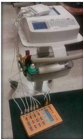
Figura 62 – Eletrocardiógrafo com o equipamento de teste.
