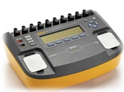
Figura 20 - Equipamento de teste de desfibriladores.
