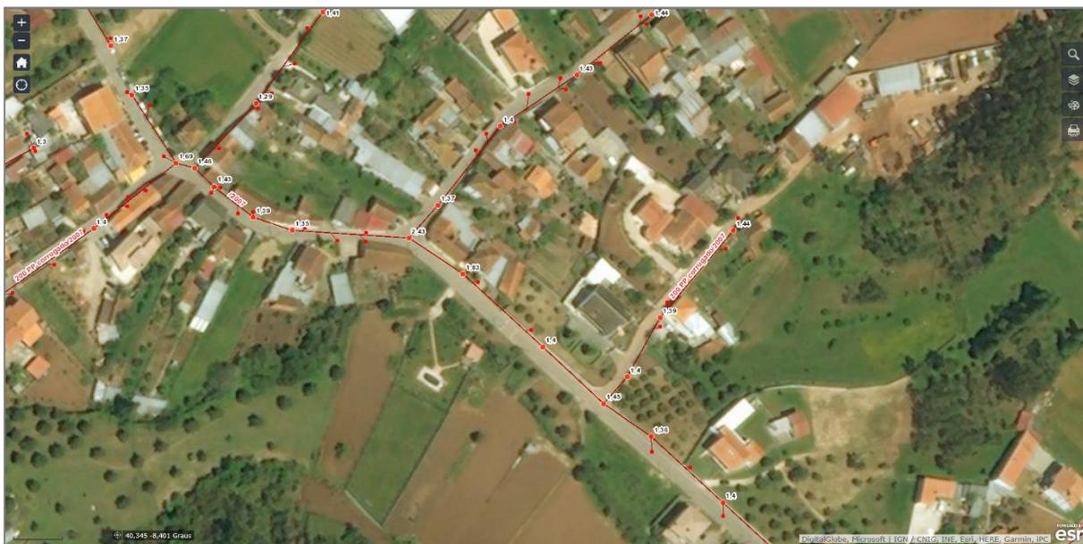
Figura 50 – Rede de drenagem de águas residuais domésticas (Imagem cedida pela Águas de Coimbra, 2017).
