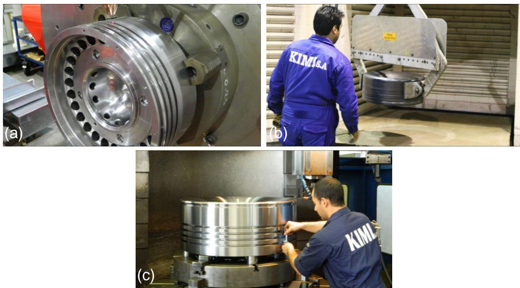
Figura 2.3 - LC em KIMI S.A. [24]: (a) reparação da coroa de um pistão em alumínio (indústria naval); (b) coroa após revestimento; (c) maquinação após reparação.
