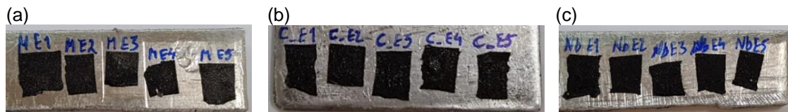
Figura 3.9 - Fixação das partículas de desgaste em fita-cola de carbono: (a) substrato; (b) matriz; (c) NbC.
