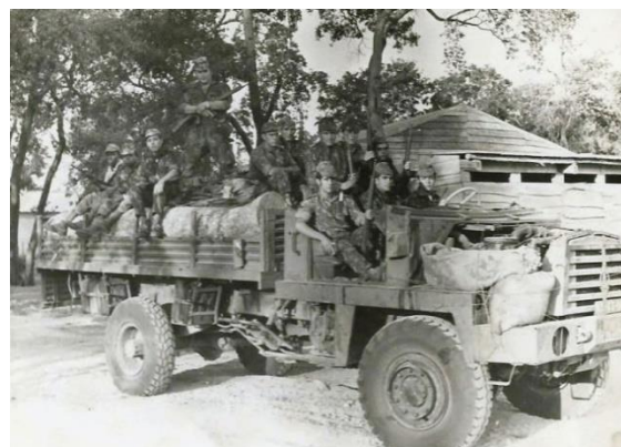
Figura 12 – Reforço de viatura com sacos de terra e remoção de portas e capô (Mota, 2014).
