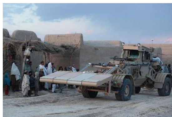
Figura 13 – Viatura de deteção da família Husky MKIII empregue nas campanhas do Iraque e Afeganistão (ArmyTechnology.com, 2017).
