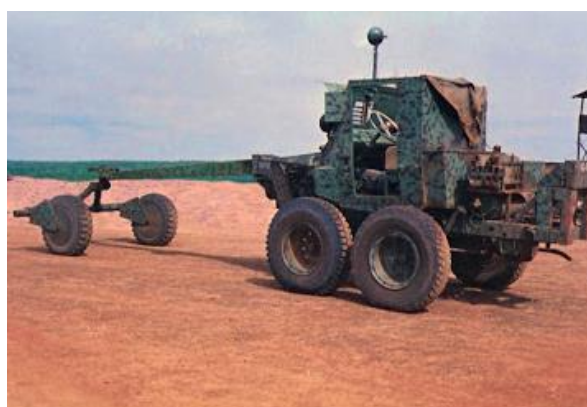
Figura 15 – Viatura rebenta minas desenvolvidos em colaboração com a Universidade de Luanda (Carvalho, 2011).
