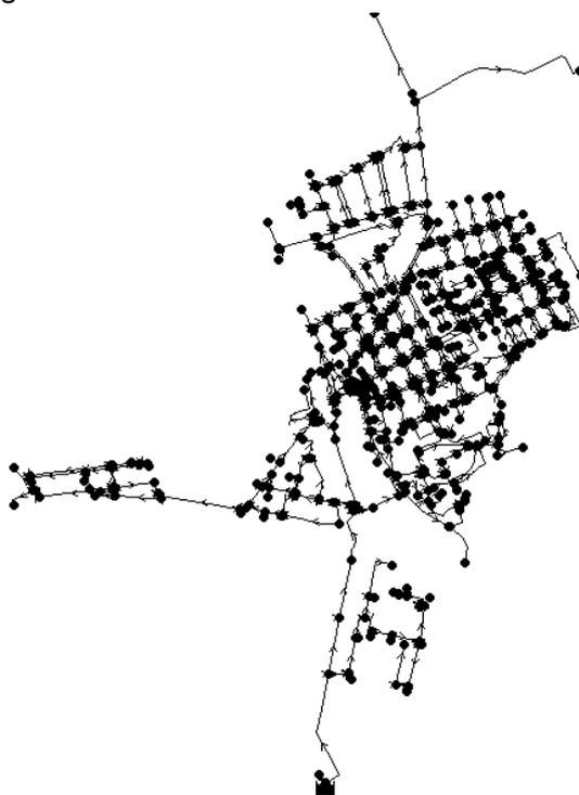
Figura 13 - Modelo EPANET da rede de abastecimento de água
