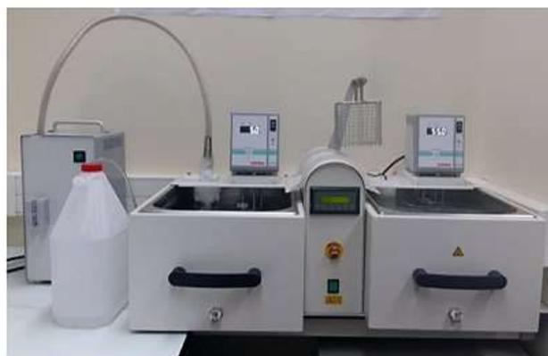
Figura 16 – Termocicladora *SD Mechatronik* (Julabo, Seelbach, Alemanha)
