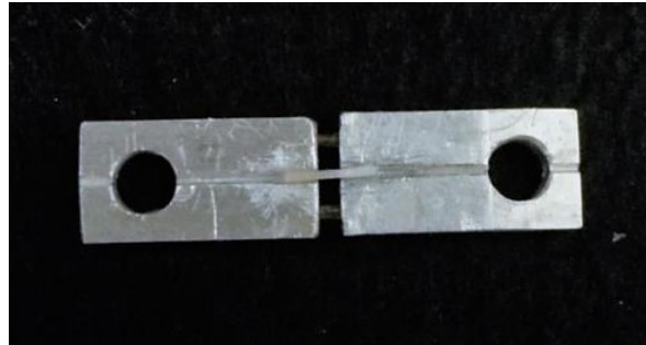
Fig. 25. Palito colado no Jig, pronto a ser testado.
