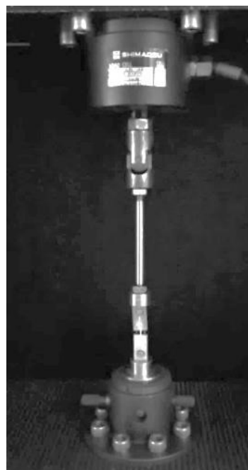
Fig. 27. Jig posicionado na máquina de teste de resistência adesiva.
