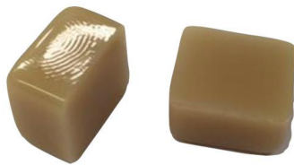
Figura 7 – Bloco de Bloco de dissilicato de lítio IPS e.max CAD A3-HT/C14 (Ivoclar-Vivadent, Schaan, Liechtenstein) dividido em duas partes iguais (12 mm x 14 mm x 7 mm) após sinterização.
