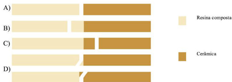
Figura 17 – Esquema representativo dos tipos de fraturas. A) Fratura Adesiva, B) Fratura Coesiva na resina composta, C) Fratura Coesiva na cerâmica, D) Fratura Mista.
