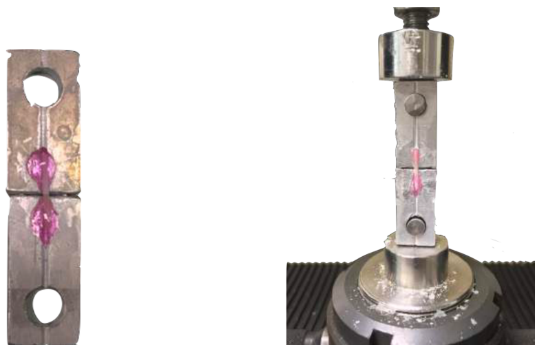
Figura 31. Palito fixado num jig de Geraldeli. Figura 32. Jig de Geraldeli na máquina de testes universal.
