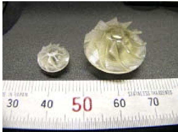
図5 マイクロ光造形による超小型3次元羽根車の形状加工
