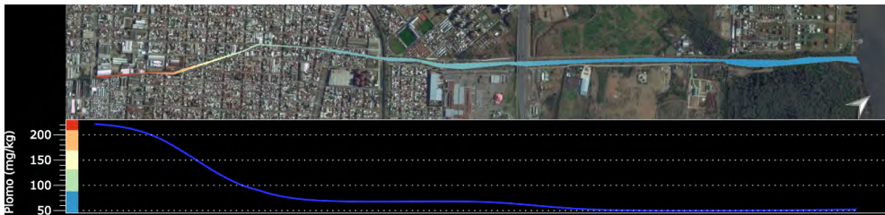
Figura 4. Distribución de la concentración promedio de plomo en los sedimentos del arroyo Sarandí.
