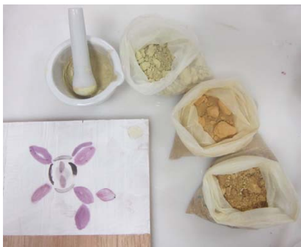
Figura 4. Probeta que muestra las combinaciones de mordientes y entonantes en la preparación del colorante carmín, y tierras amarillas recolectadas en Cusihiuriachi. Foto: K. Muñoz Alcocer
