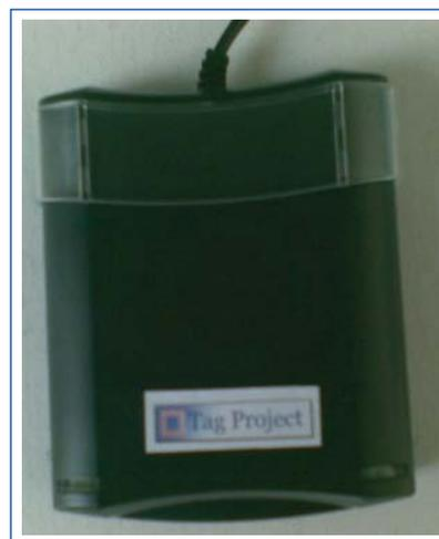
Figura 6 - Lettore/scrittore RFID palmare
