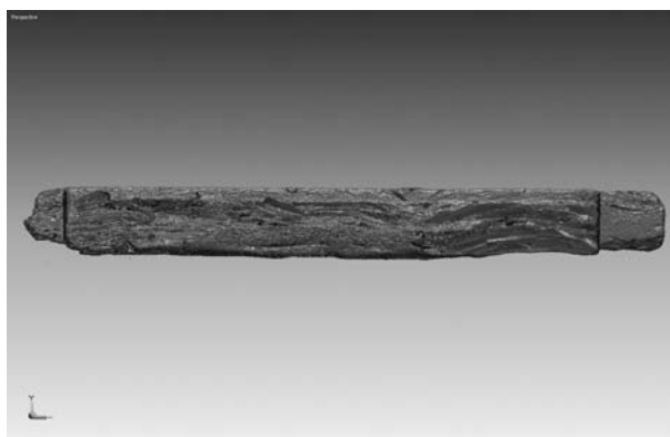
FIG. 8 - Visualizzazione del modello 3D, ottenuto con l'uso del Laser 3D scanner Vi-900 del DIAPREM della Facoltà di Architettura dell'Università di Ferrara (foto T. Lanave).
