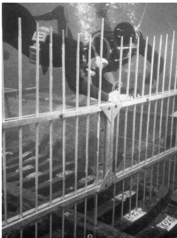
Fig. 6 - Profilometro o pettine utilizzato sul relitto di Cala Culip VI per rilevare le sezioni dello scafo (da PALOU et al. 1998).
