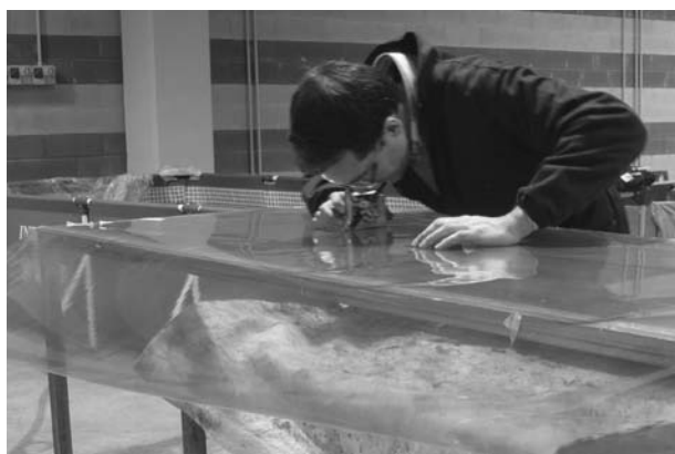
FIG. 13 - Operazioni di rilevamento in scala 1:1 con lastra di plexiglass su telaio (foto dell'autore).
