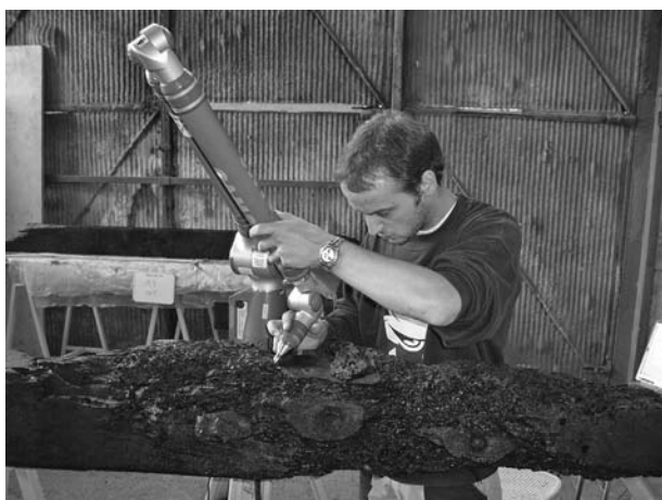
FIG. 9 - Utilizzo del braccio misuratore Faro arm per rilevare un elemento di imbarcazione dal relitto "del Molo Sud" di Malamocco (Venezia) (foto dell'autore).
