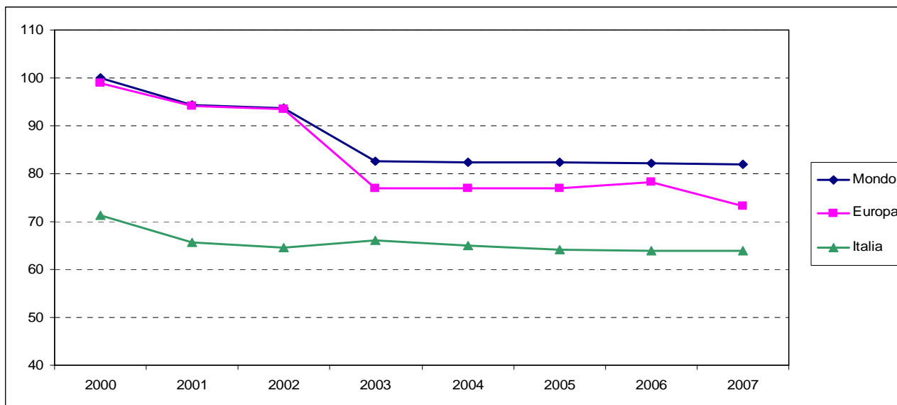
Figura 3.13 - Intensità di carbonio per produzione termoelettrica in Italia e confronto con media europea e mondiale (intensità di carbonio media mondiale nel 1997 = 100)
