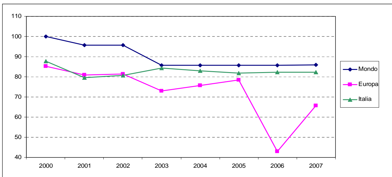
Figura 3.14 - Intensità di carbonio per produzione elettrica in Italia e confronto con media europea e mondiale (intensità di carbonio media mondiale nel 1997 = 100)
