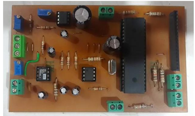
Figura 13. Circuito de adquisición de peso y altura
