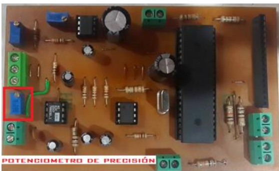
Figura 11. Vista del potenciómetro de precisión
