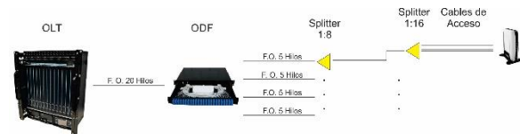
Figura 6. Distribución de hilos de fibra óptica
