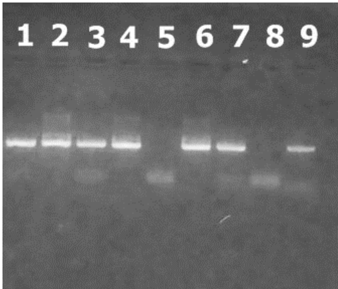
Figura 3. Electroforesis en Gel de Agarosa al 2%. Productos amplificados por PCR para la región VP1/VP2 del virus JC. Calles 1 a 4 y 6: Muestras positivas. Calle 5: Muestra negativa. Calle 7: Control positivo. Calle 8: control negativo. Calle 9: marcador interno.
