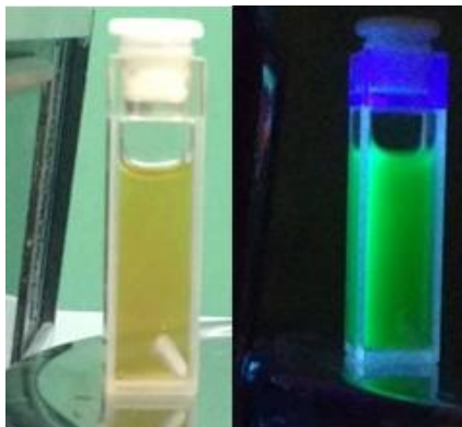
Figura 63. Suspensión conjugado MNPSINH-F 4 Ph-BOD-H 2 . Irradiación UV de 254 nm (A). Sin irradiación (B).
