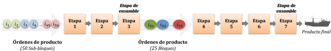
Figura 3.5. Estructura del proceso productivo – Ejemplo 3.1.
