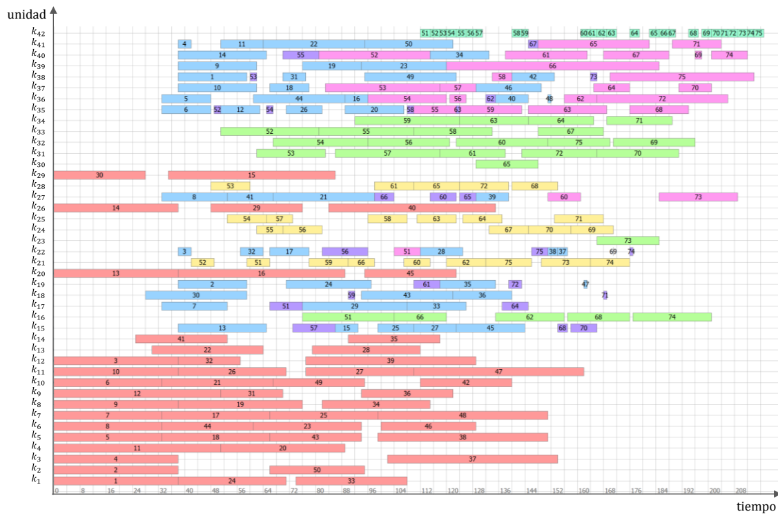
Figura 4.20. Mejor solución reportada por el algoritmo reasignando unidades y tareas para el caso de estudio 2 ( Heurística 1 ) – MK = 217,5 días.
