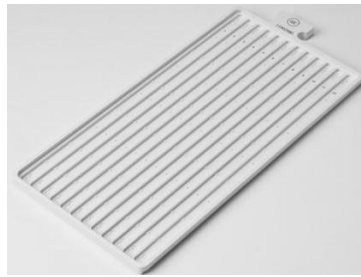
Figura 6.3. Manifold. En cada uno de los canales del manifold se colocaron las tiras del isoeléctrofocado con el gel hacia arriba.
