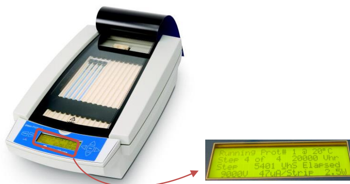
Figura 6.4. Equipo Ettan IPGphor para correr la primera dimensión. Se puede observar el detalle de la pantalla donde se van reportando todas las etapas de las condiciones utilizadas durante la corrida.
